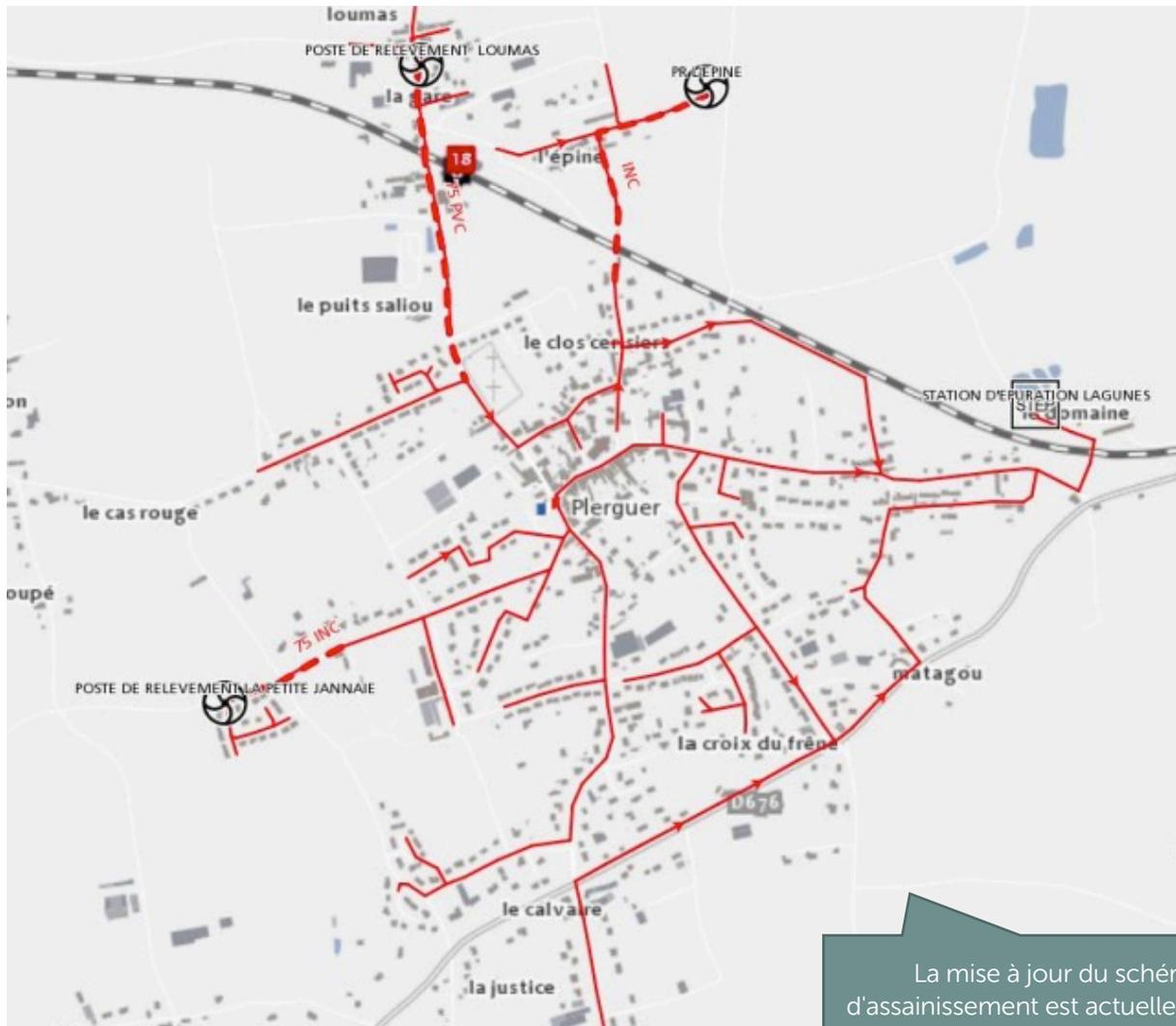
Réseau d'assainissement collectif sur le bourg de Plerguer (les réseaux en pointillé représentent les canalisations de refoulement).
